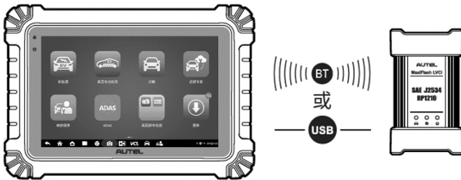
图 6-4 平板诊断设备与 VCI 设备连接示意图
