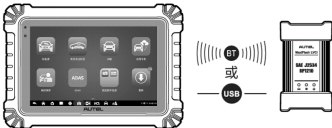
图 6-16 平板诊断设备与 VCI 设备连接示意图
