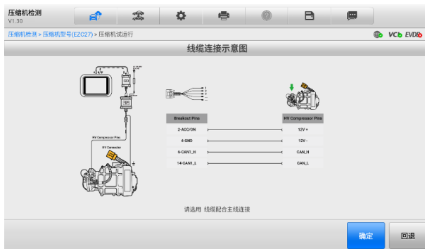
图 6-9 线缆连接示意图 - CAN 协议
