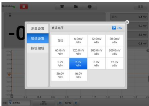
图 9-78 幅值设置示意图 (直流电压 2.0 V/div)
