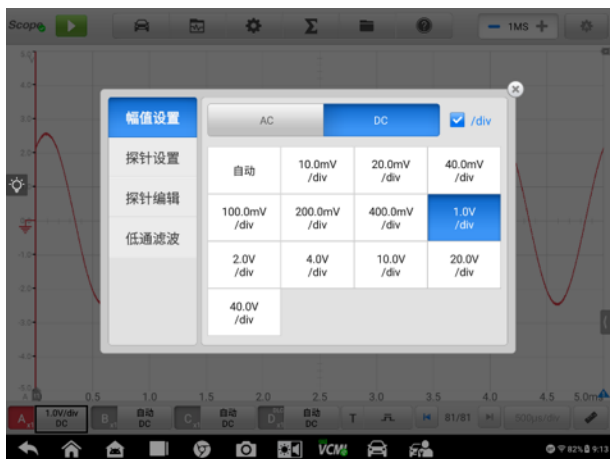
图 9-43 “幅值设置” 界面示图 1 (DC 1.0V/div)
