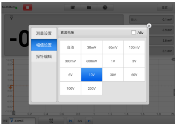
图 9-77 幅值设置示意图 (直流电压 10 V)
