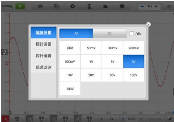
图 9-41 “幅值设置” 界面示图 1 (AC 5 V)
