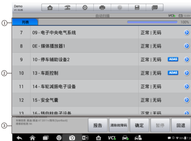
图 4-2 自动扫描操作界面示意图
