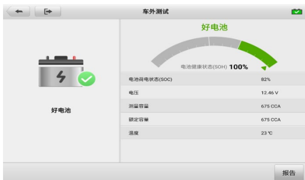
图 16-10 “电池检测结果” 界面示图
