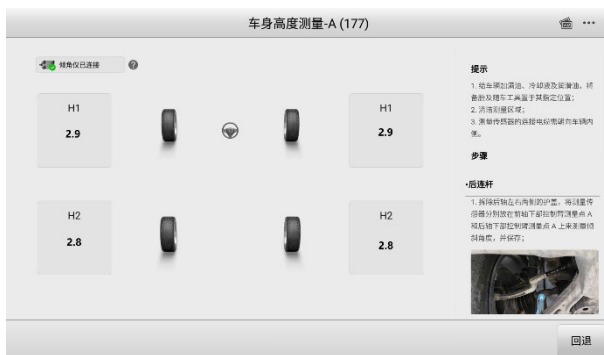
图 25-3 车身高度测量结果示图
