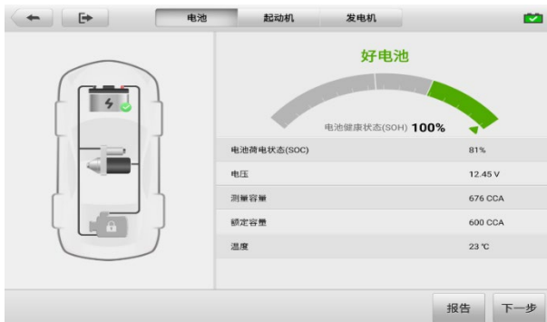
图 16-6 “电池检测结果” 界面示意图
