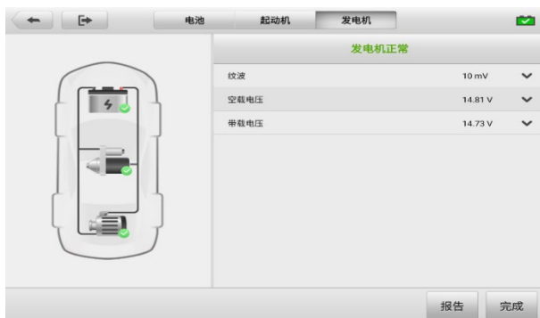
图 16-8 “发电机检测结果” 界面示图
