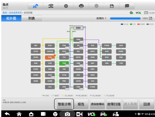
图 5-2 通过智能诊断功能按钮 (拓扑图显示界面)
