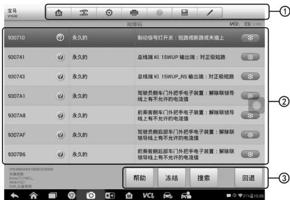
图 4-9 “读故障码”界面示意图
