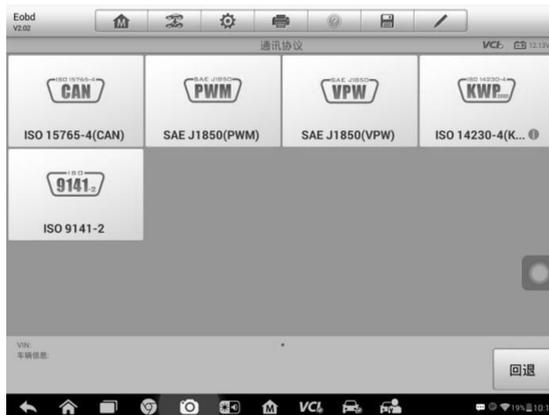
图 4-14 “OBD II 诊断菜单”示图
